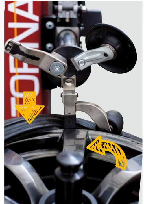
**E-F.** Durch die Positionierung des Montagewerkzeugs des WERKZEUGREVOLVERS zwischen Felge und Reifen sorgt die KUNSTSTOFFROLLE des WERKZEUGREVOLVERS automatisch dafür, dass der Reifen im Felgenbett bleibt.
